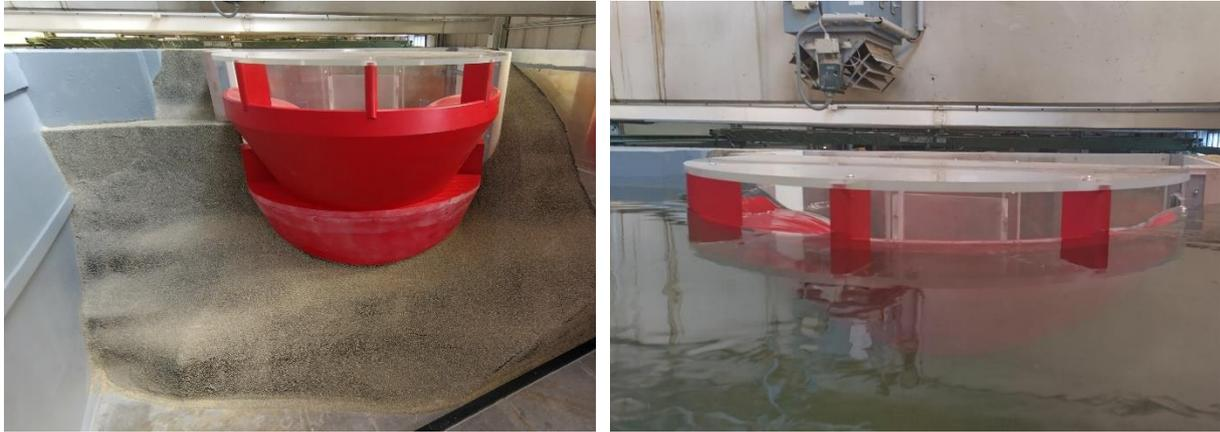
Abbildung 3: Neues Einlaufbauwerk im Modell 1:15
