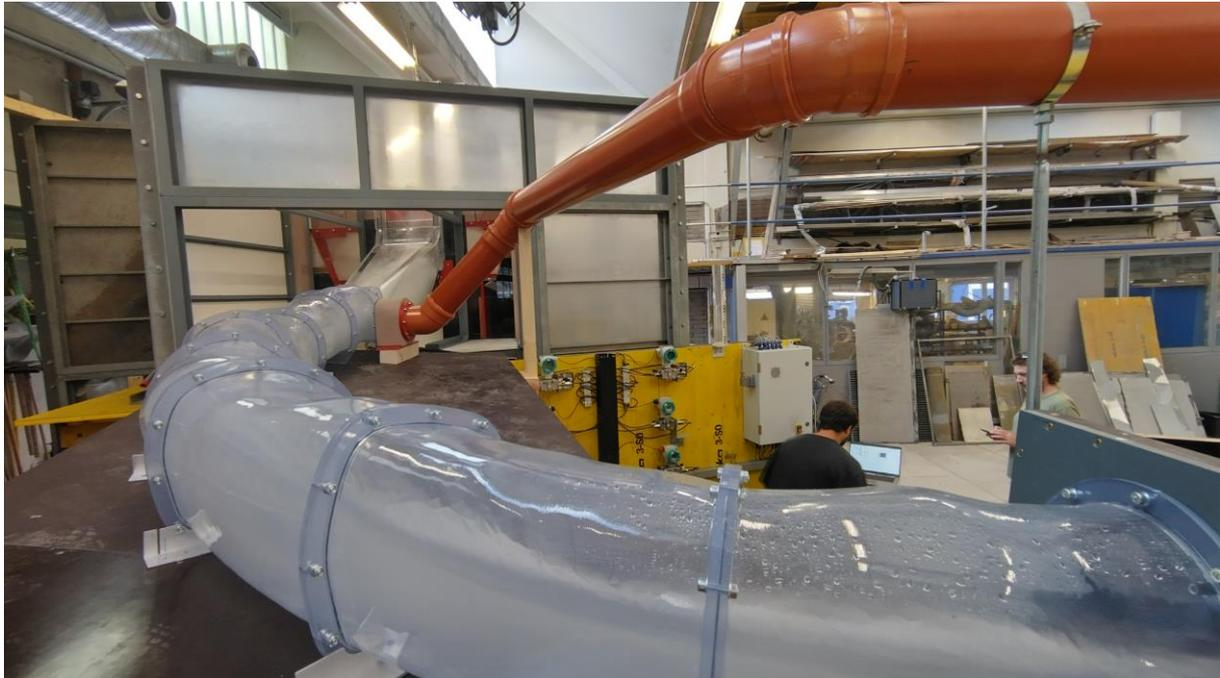
*Abbildung 5: 3D-gedruckter Stollenbereich im Modell in Betrieb*
