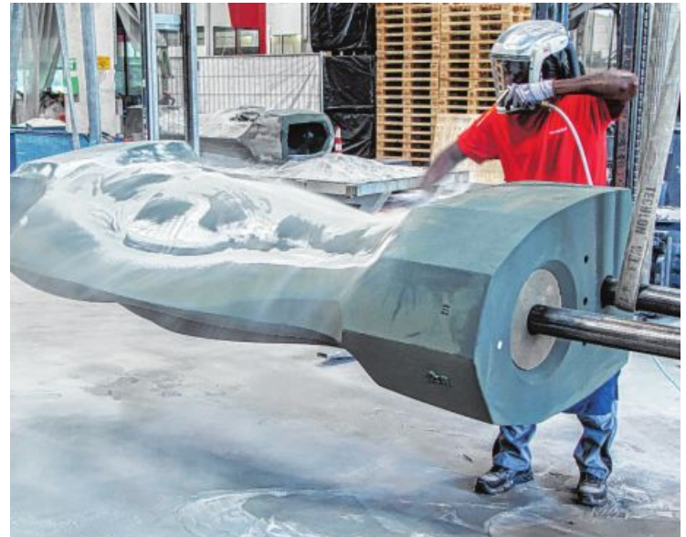
Drei große Plastiken wie diese stehen auf 2500 Metern Seehöhe: Die Objekte sind bisher die weltweit größten 3D-Drucke aus Quarzsand.
