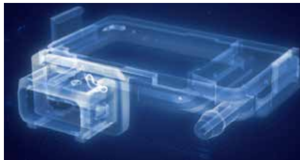
Visualisierung der Lunker an Volumendaten
